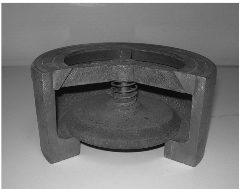
Рис. 1. Внешний вид обратного клапана «ОКТАМ», отработавший в системе теплоснабжения 3 года
