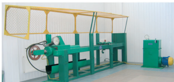
Рис. 2. Стенд для испытания строп. Простой станок с одним электродвигателем в качестве основного привода
