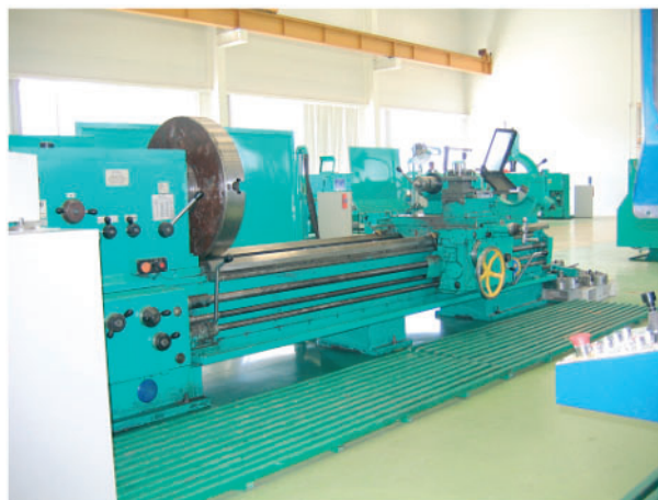
Рис. 1. Большой токарный станок. Этот станок содержит большое количество электродвигателей, у каждого из которых специальное назначение
