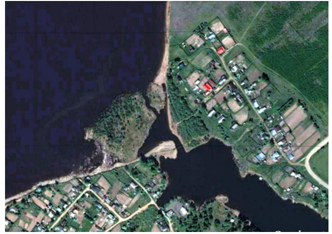
Рис. 2. Плавающий остров остановил потоки вдольбереговых наносов и стимулировал развитие широкого пляжа и береговой террасы
