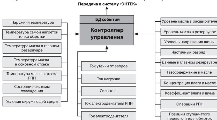
Рис. 3. Контроль силовых трансформаторов 10 кВ
