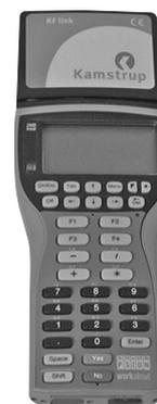
Рис. 2. Ручной терминал MULTITERM®
