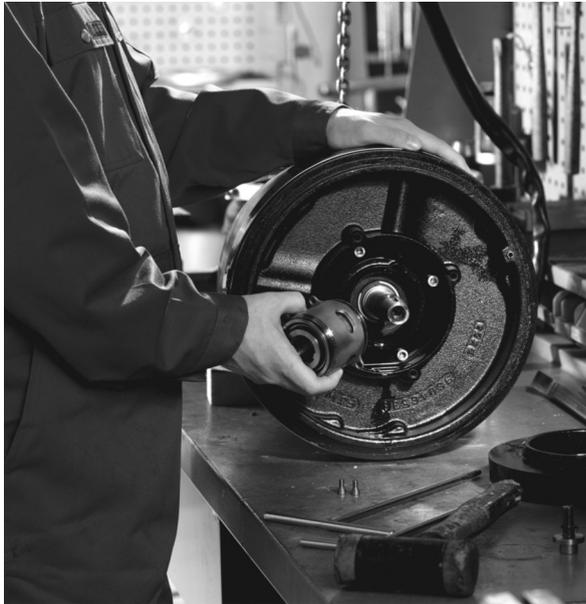
Рис. 4. Быстросменяемое картриджное торцевое уплотнение
