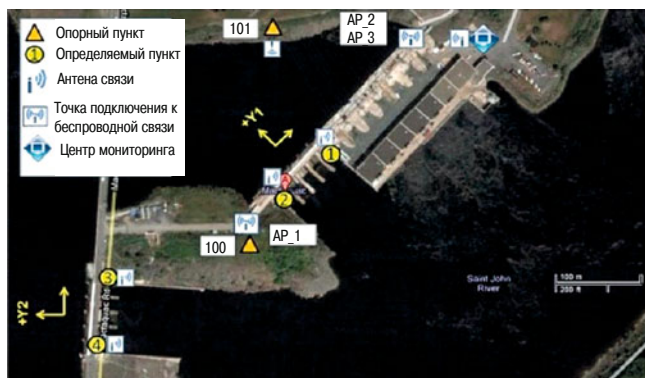
Рис. 3. Система мониторинга плотины ГЭС Мактакак [14]
