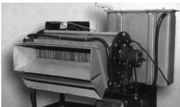
Фото 1 Вентиляционная очистительная установка МВУ-1000
