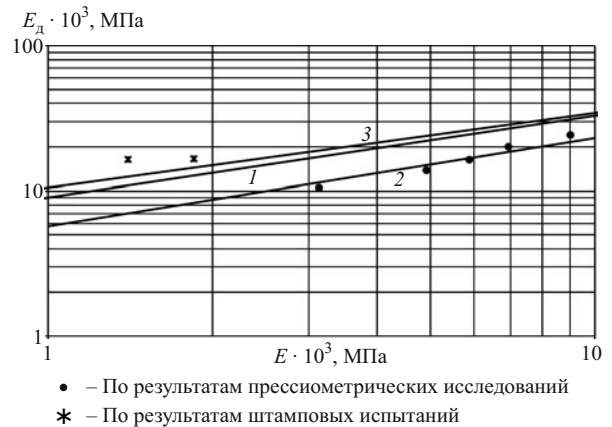
Рис. 10. Графики связи величин E и E_d для пород участка Богучанской ГЭС: 1 – график связи из работы [1]; 2 – график связи величин E_{II} и E_d по данным выполненных работ; 3 – график связи величин E_{\Sigma} и E_d , построенный на основании графика 2
