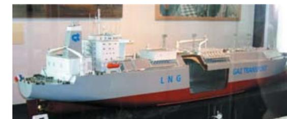
**Рис. 5. Танкер СПГ мембранного типа, грузоподъемность 130000 м³** (© Remi Kaupp)
