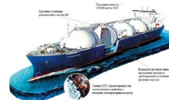
**Рис. 4. Танкер СПГ типа MOSS для проекта «Сахалин-2»**
