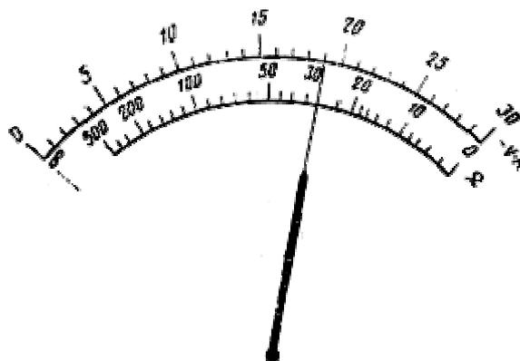
Изменяя сопротивление магазина, устанавливают последовательно стрелку прибора на отметки 19 и 20 равномерной шкалы. При этом получены значения сопротивления 32,3 и 28,0 Ом.
