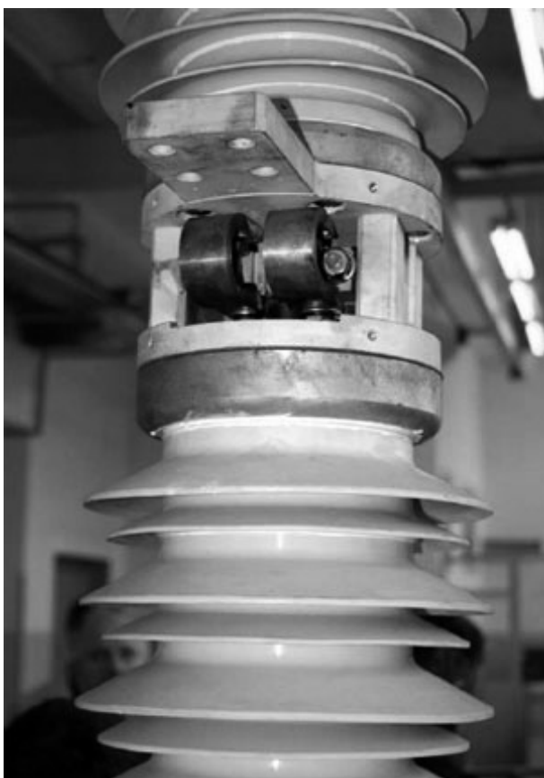
Полюс вакуумного выключателя 35 кВ с кремнийорганической изоляцией полюсов. Снята крышка соединения дугогасительного модуля и модуля тяги контакта
