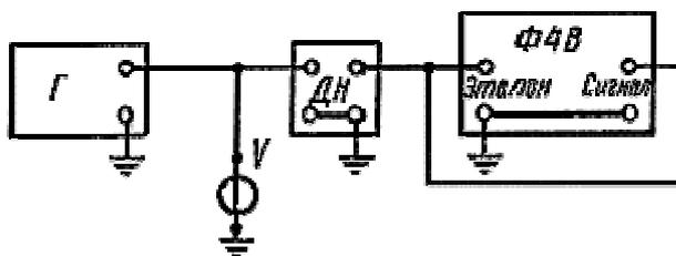
Г - измерительный генератор; V - образцовый вольтметр;
