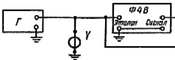
Г - измерительный генератор; V - образцовый вольтметр;
