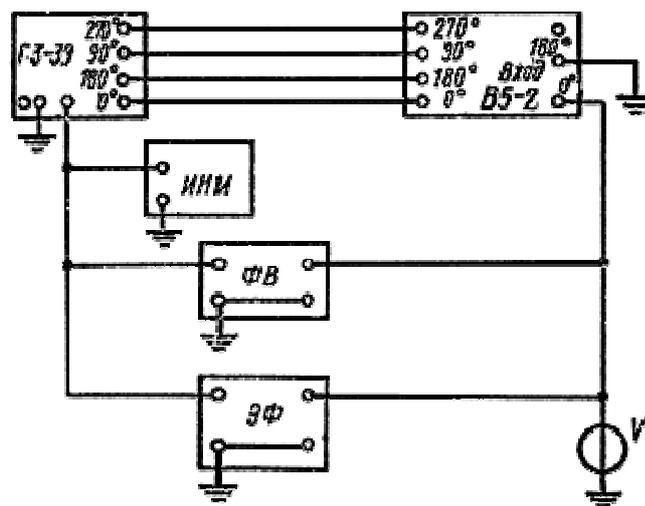
Р - измерительный генератор; ФВ - фазовращательное устройство;
