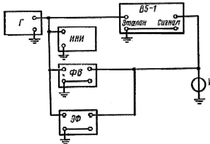
Схема поверки вольтметра В5-2
