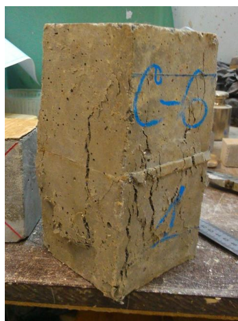
Рисунок 1. Установка для определения статического модуля деформации, образец после разрушения
