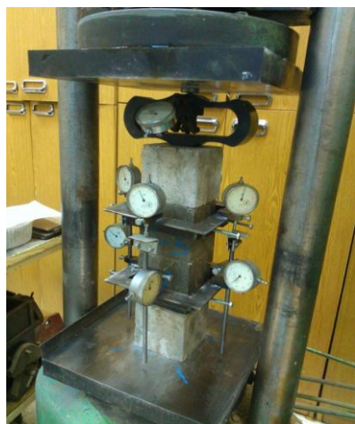
Рисунок 1. Установка для определения статического модуля деформации, образец после разрушения
