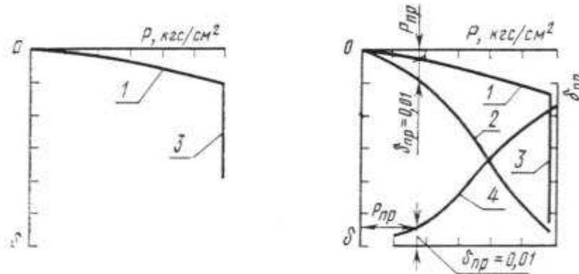
1, 2 - относительное сжатие  $\delta$  грунта с природной влажностью и в водонасыщенном состоянии в зависимости от давления; 3 - дополнительное относительное сжатие грунта в результате замачивания (относительная просадочность) при заданном давлении; 4 - зависимость относительной просадочности  $d_p$  от давления;  $P_{пр}$  - начальное просадочное давление
