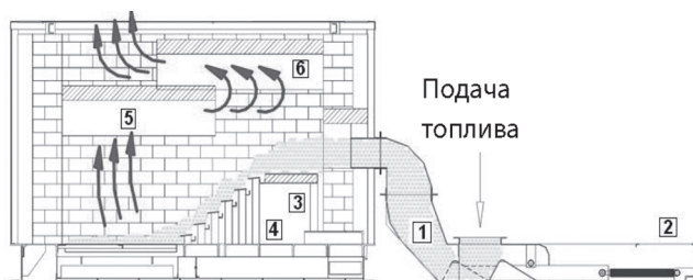
Рис. 1. Топка котла «Экотерм-Универсал» на древесных отходах. 1. Питатель топлива; 2. Гидроцилиндр; 3. Горизонтальный колосник; 4. Наклонный колосник; 5. Арочный радиационный свод (зона предварительного горения); 6. Арочный радиационный свод (зона окончательного горения)
