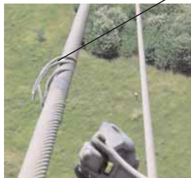
Рис. 6. Повреждение элементарных проводников высоковольтной линии и определение зоны повреждения системой DayCor II (справа).
