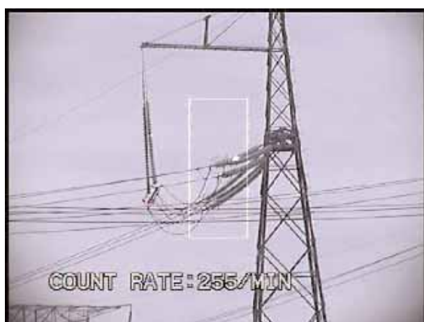
Рис.4. Корона на дефектных подвесных изоляторах высоковольтных линий
