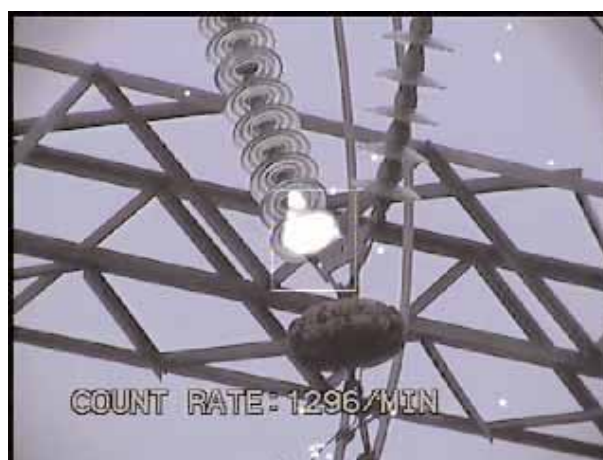
Рис.4. Корона на дефектных подвесных изоляторах высоковольтных линий
