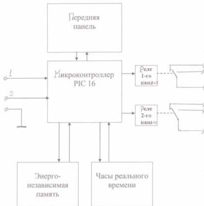
Рис. Блок-схема таймера УТ1-РiС: 1, 2 – логические входы
