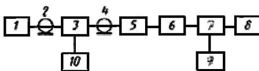
*1* - измерительный генератор; *2, 4* - коаксиальный кабель;
