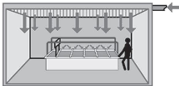
Рис. 2. Система воздухораспределения поршневого типа с подачей через перфорированный потолок. Этот способ может быть использован для вентиляции гальванических цехов
