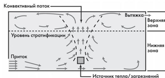
Рис. 5. Пассивная термовытесняющая вентиляция
