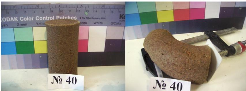
Рис. 3. Образец криогелевого грунтового композита после оттаивания. (слева – перед приложением изгибающего усилия, справа – при приложении)
