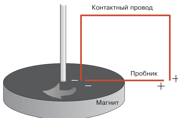
Рис. 1. Униполярный установочный магнит, пробник и контактный провод
