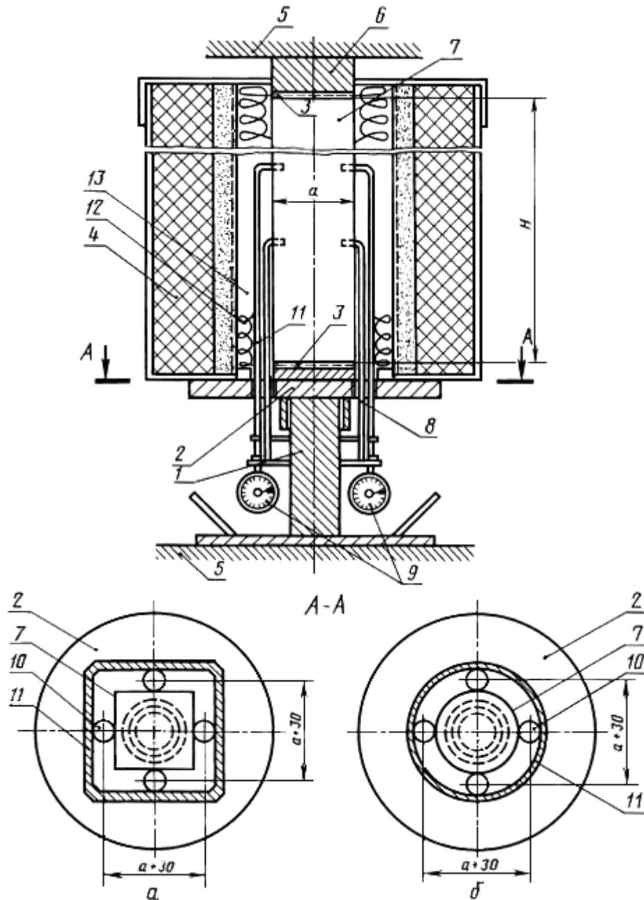
1 - опорный столик; 2 - съемная опорная плита столика с приваренным к ней оголовником; 3 - теплоизоляция из асбеста; 4 - электрическая печь; 5 - опорная плита; 6 - плита-вставка; 7 - образец; 8 - выносные удлинители; 9 - индикаторы; 10 - отверстия в съемной опорной плите для пропуска удлинителей; 11 - фиксатор для установки печи; 12 - теплоизоляция из ваты; 13 - термопара в рабочем пространстве печи.
