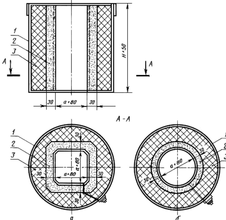
1 - металлический кожух; 2 - муфель из жаростойкого раствора с нагревателем из проволоки повышенным омическим сопротивлением; 3 - теплоизоляция;  $a$  - размер стороны призмы или диаметра цилиндра;  $H$  - высота образца
