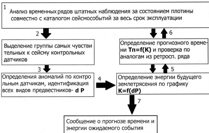
Рис. 80. Алгоритм прогноза землетрясений с помощью измерительных систем плотин
