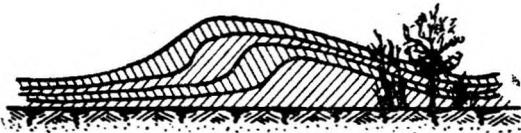
Фиг. 14. Неравномерное распределение толщины снежного покрова вследствие наличия препятствий.
