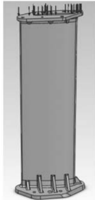
Рис. 4. Модель колонны №15 (нагрузка на верхний башмак 7,81 МПа)
