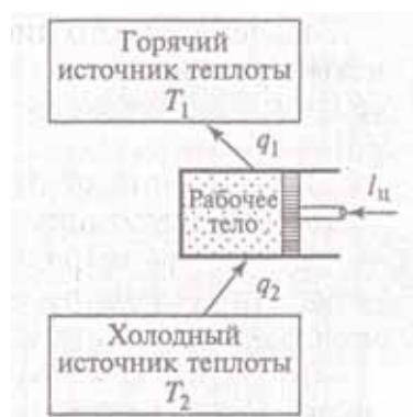
Рис. 1. Термодинамическая схема холодильной машины и теплового насоса
