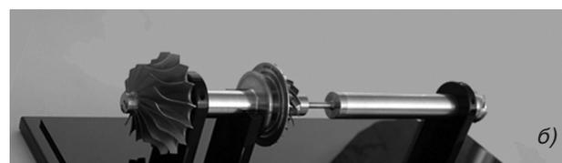
Рис. 6. Внешний вид турбогенератора (а) и единый вал турбогенератора (б)
