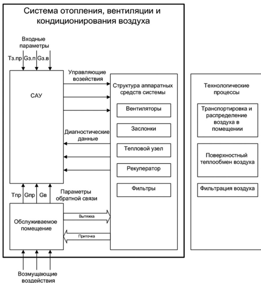
Рис. 1. Обобщенная структурная схема системы отопления, вентиляции и кондиционирования воздуха в помещении, где  $T_{пр}$ ,  $G_{пр}$ ,  $G_{в}$  – температура приточного и вытяжного воздуха и расход приточного и вытяжного воздуха, а  $T_{з.пр}$ ,  $G_{з.п}$ ,  $G_{з.в}$  – задания на температуру приточного и на расход приточного и вытяжного воздуха
