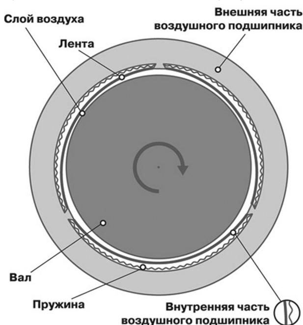
Рис. 7. Схема воздушного подшипника МТУ
