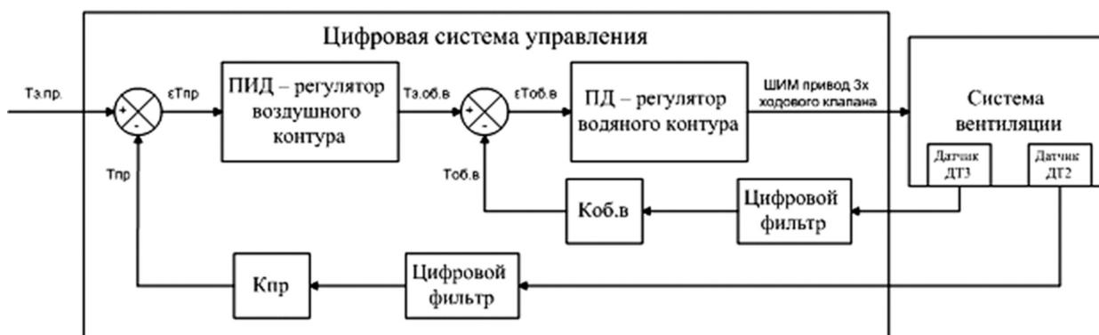
Рис. 4. Двухконтурная система подчиненного регулирования
