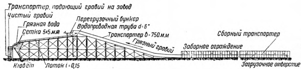
Фиг. 61. Схема лотковой гравиемойки Волжского района
