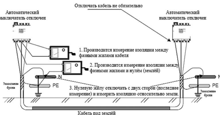
**Рисунок 3. Измерение сопротивления изоляции силового кабеля в действующей электроустановке.**
