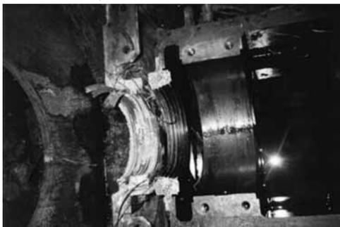
**Рис. 4 Внешний вид уплотнения нагнетателя сернистого газа после вскрытия проточной части машины**
