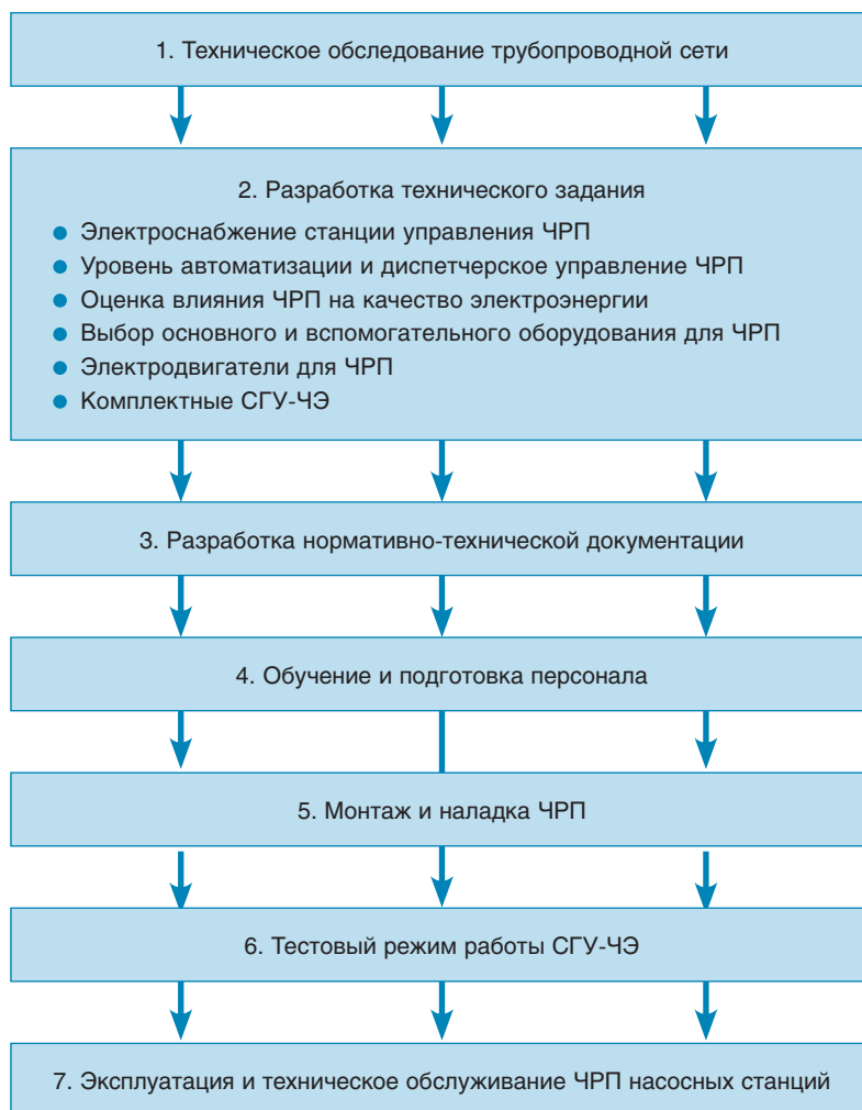
Рис. 1. Аспекты внедрения ЧРП на объектах водоснабжения
