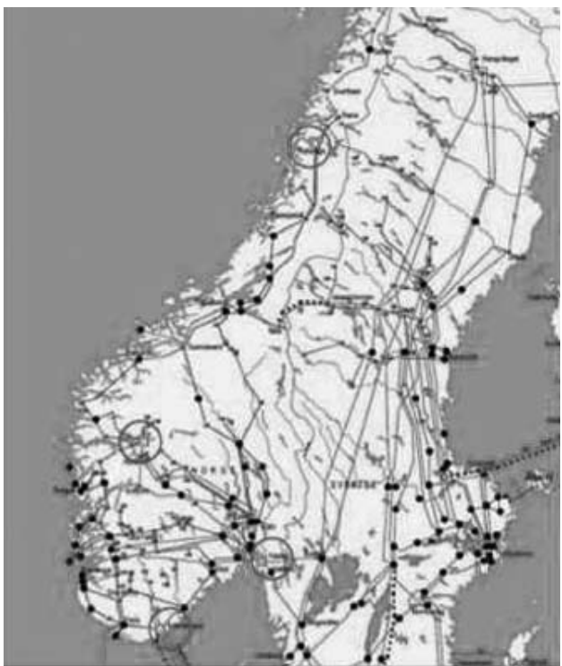
Рис. 1. Сеть линий электропередачи Nordic и места, где установлены устройства PMU (обведены красными кругами)
