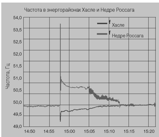
Рис. 2. Восстановление синхронизма между сетями Южной Норвегии (подстанция Хасле) и Северной Норвегии (подстанция Недре Россага) 1 декабря 2005 г.
