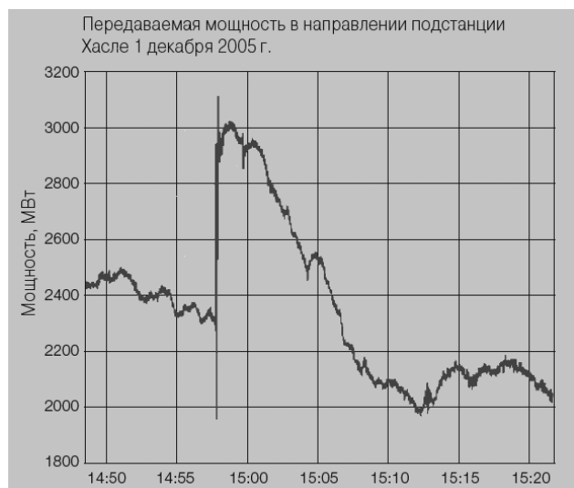
Рис. 3. Мощность, передаваемая по линиям 420 кВ от подстанции Хасле в сторону Швеции
