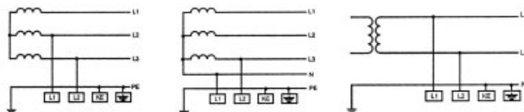
Рис. 2. Подключение АСТРО-ИЗО-470 в различных типах сетей
