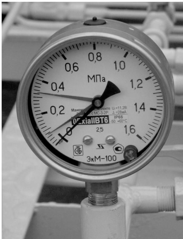
Рис. Манометр ЭКМ-100
