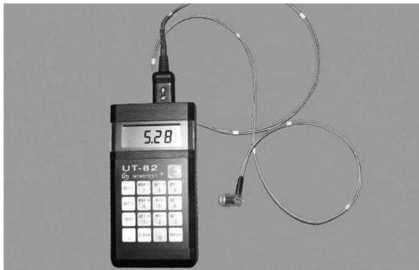
Рис. 5. Ультразвуковой толщиномер УТ-82
