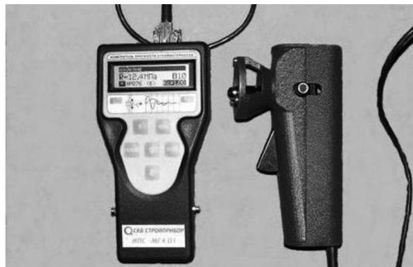
Рис. 1. Прибор для определения фактической прочности бетона фундаментов «ИПС-МГ4.01»
