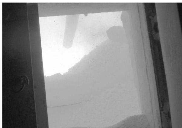
Рис. 4. Люк откатной головки вращающейся печи, через который производилось наблюдение за выходом образцов
