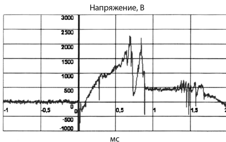
Рис. 4. Осциллограмма напряжения при энергии дуги 51 кДж
