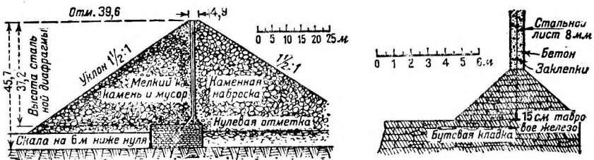
Фиг. 164. Разрез плотины Лоуер Отэй п разрез стальной диафрагмы у подошвы в увеличенном масштабе.
