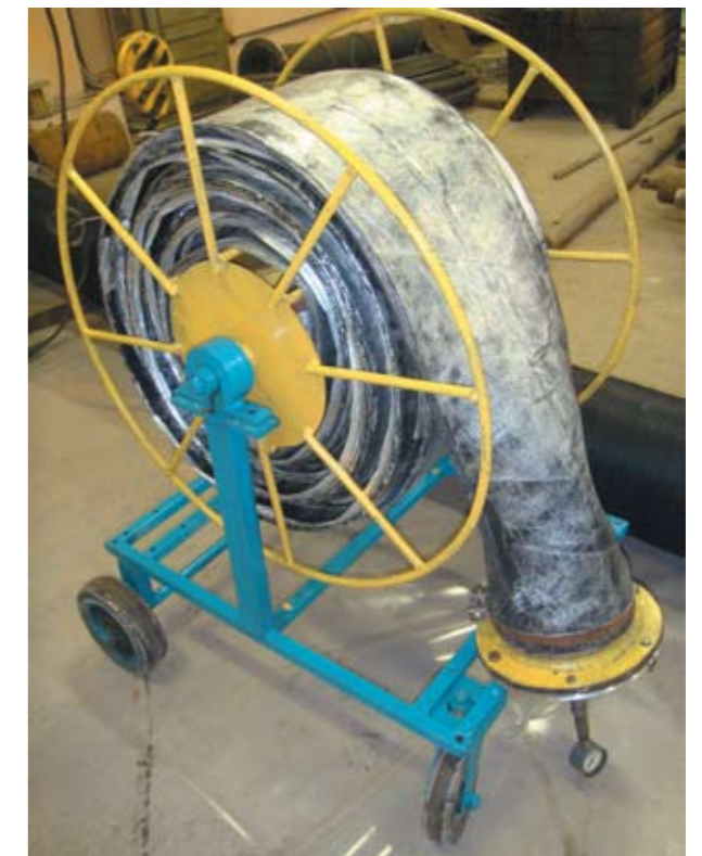
Рис. 4. Плоский грунтопровод диаметром 219 мм, длиной 30 м, намотанный на барабан
