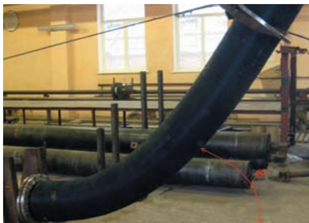
Рис. 1. Всасывающий грунтопровод диаметром 325 мм
