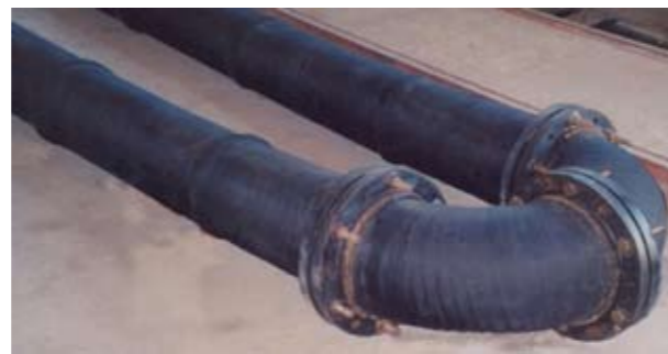
Рис. 9. Элементы корпусного грунтопровода
