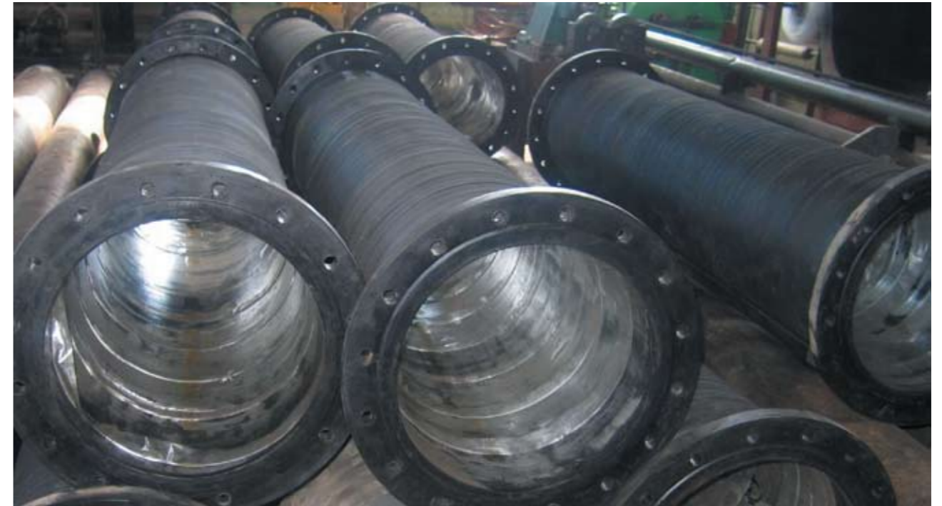
Рис. 10. Элементы корпусного грунтопровода
