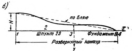
Фиг. 212. Распределение давления по шпунту и флютбету при одношпунтовом флютбете.
