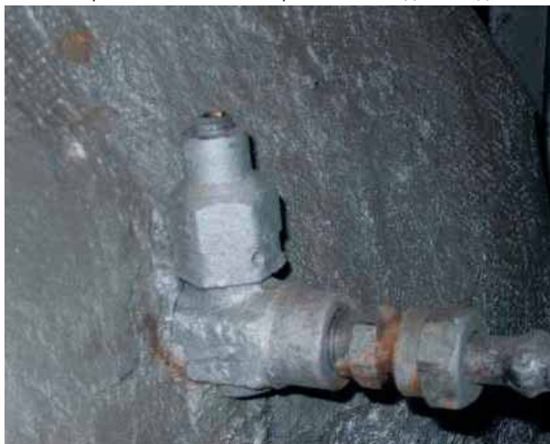
Клапан запорный игольчатый со сломанным штоком на манометрической сборке верхнего барабана котла.
