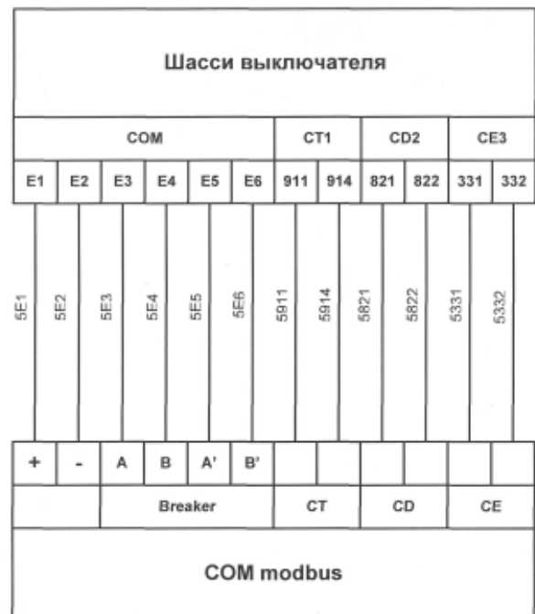
Рис. 4. Схема подключения дополнительной функции передачи данных COM в АВ Masterpact
