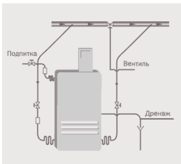
Рис. 8. Типичная схема подключения вакуумного деаэрата
