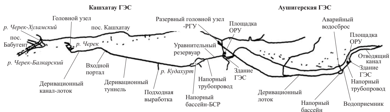
Рис. 1. Каскад Нижнечерекских ГЭС
