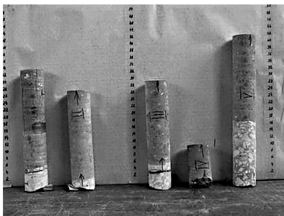
Рис. 11. Керны, выбуренные из отремонтированной ЗПУ Саратовской ГЭС
