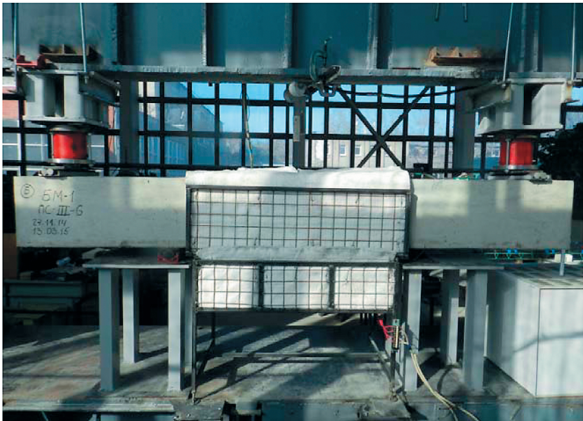
Рис. 7. Железобетонная модель БМ-1 в стенде для испытания на температурное воздействие
