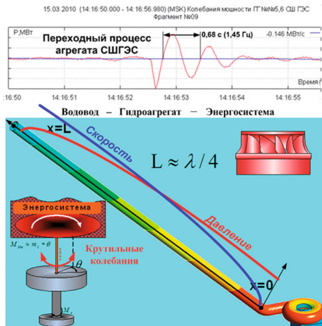
Рис. 8. “Органный” резонанс агрегата Саяно-Шушенской ГЭС
