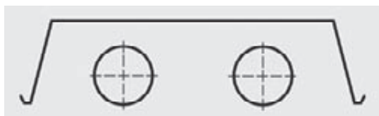
Рис. 2. Конструкции отражателей идеального U-образного ИТГО
