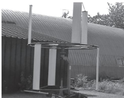
Рис. 5. Полевые виброиспытания ВЭУ-3 (шестилопастная, двухъярусная).
