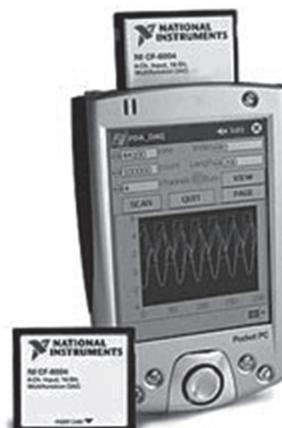
Рис. 3. Портативный прибор для вибрационных измерений на базе карманного компьютера NI CF-6004
