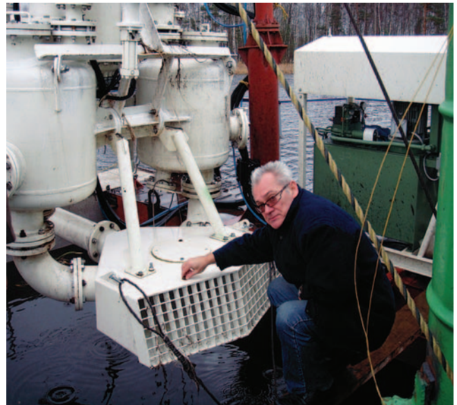
Рис. 4. Камеры насоса ПКН 60/10P-VS и грунтозаборный ковш итальянской фирмы “Pneuma”
