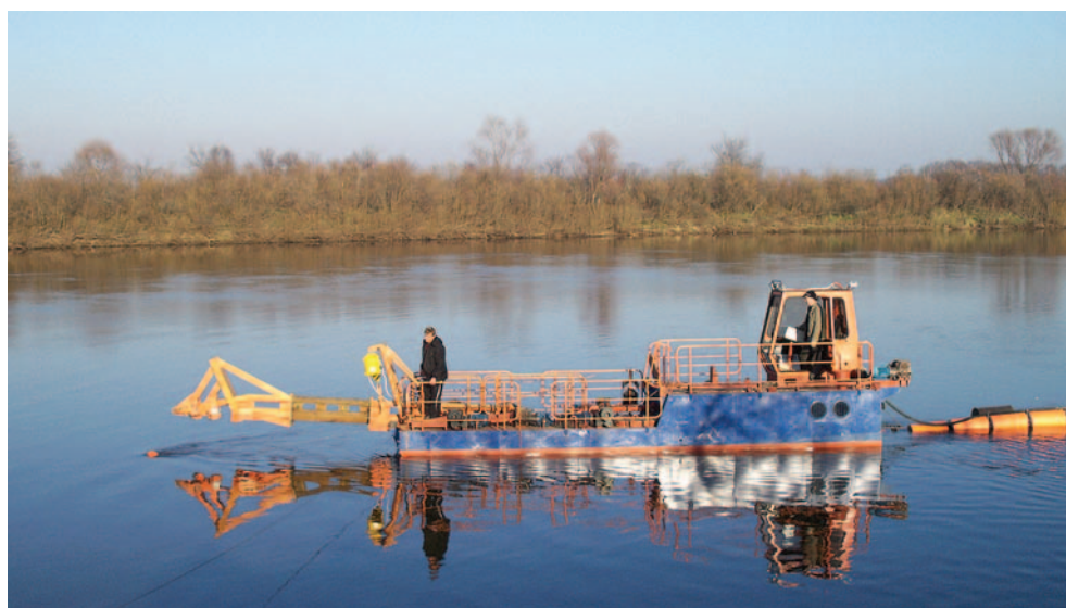
Рис. 4. Гидромониторный грунтоприемник с принудительным подводом грунта землесоса проекта 258.Г80
