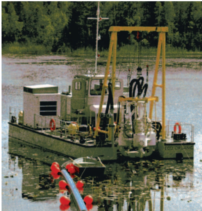
Рис. 3. Общий вид земснаряда DR60/10P с пневматическим камерным насосом
