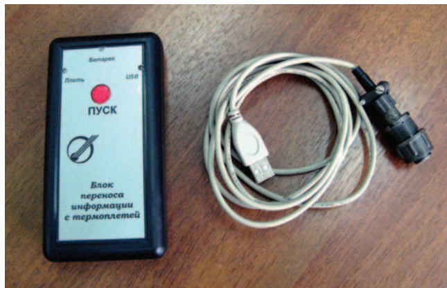
Рис. 2. Блок переноса информации с термоплетей
