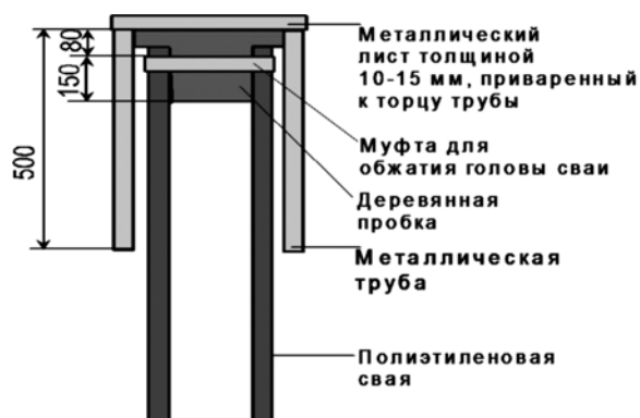
Рис. 2. Подготовка головы полиэтиленовой сваи к испытаниям
