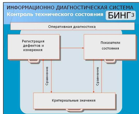
Рис. П20.5 Схема оперативной диагностики
