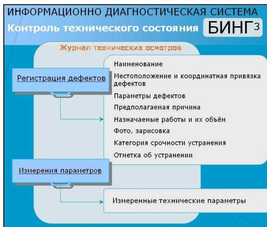
Рис. П20.4 Занесение результатов технических осмотров
