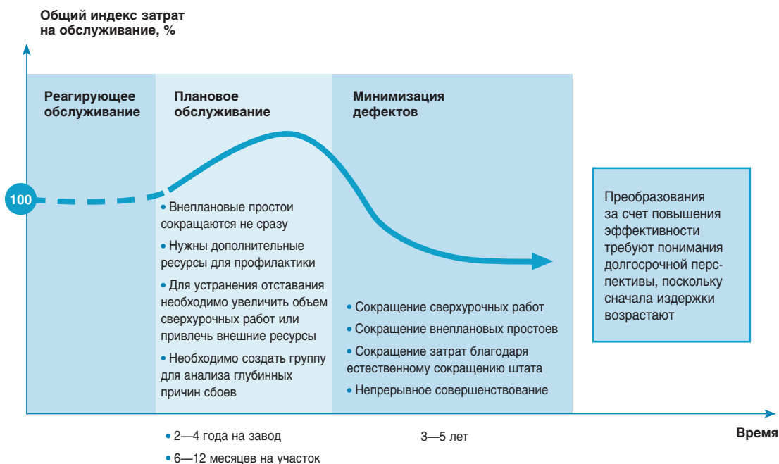
Схема 7. Изменение издержек при переходе от реагирующего обслуживания к плановому
