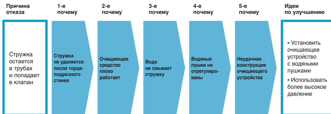
Схема 5. Пример глубинного анализа проблемы на металлургическом предприятии: «пять "почему"»
