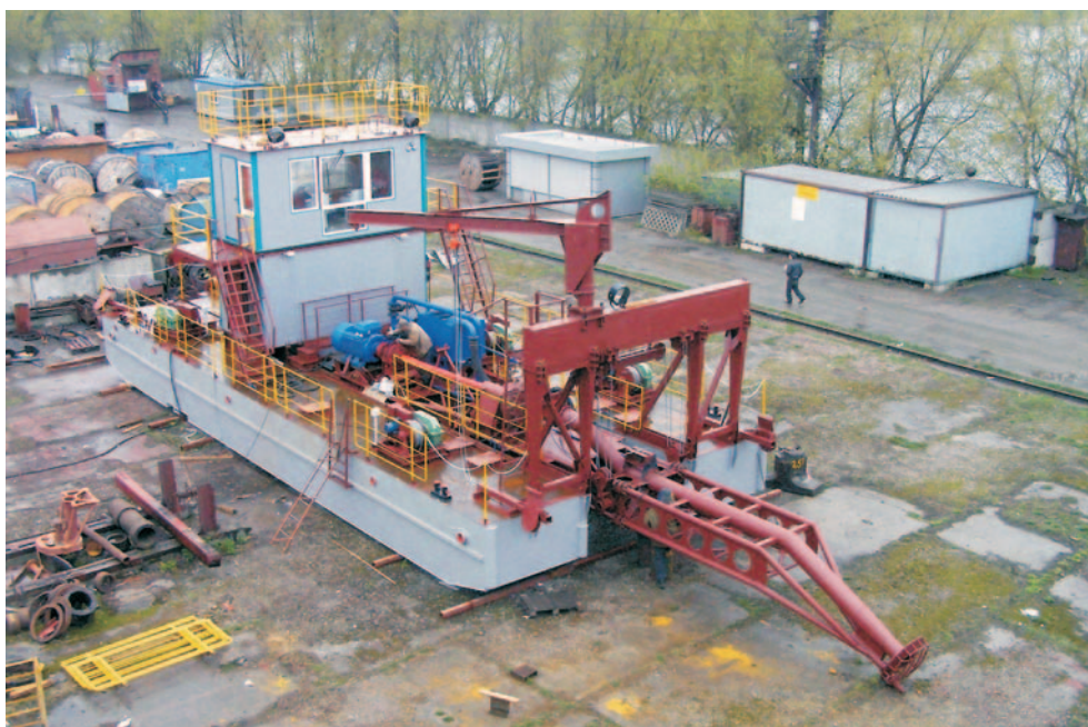
Рис. 2. Земснаряд ЗЭК 800/40 с частотным регулятором электропривода погружного грунтового насоса на монтажной площадке ОАО “Промгидромеханизация”
