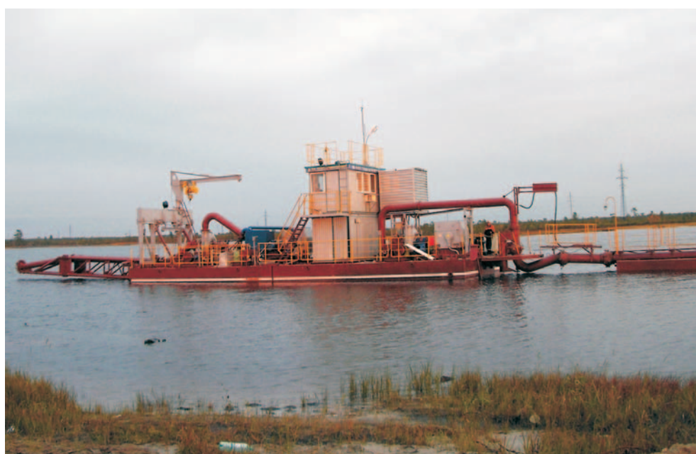
Рис. 1. Земснаряд ЗЭК 1400/40+23 с погружным и палубным грунтовыми насосами
