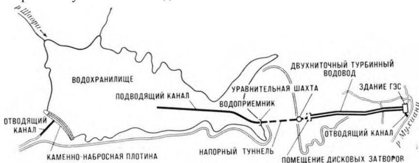
Рис. 2-66. Схема сооружений Шаорской ГЭС.
