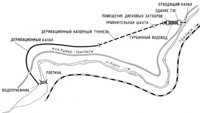
Рис. 2-10. Общая схема гидротехнических сооружений Читавской ГЭС.
