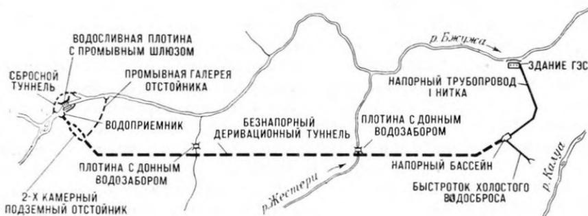
Рис. 2-94. Схема сооружений Бжу́жской ГЭС.
