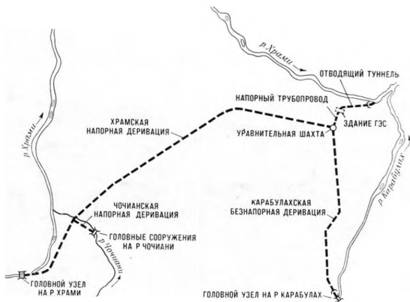
Рис. 2-50. Схема гидротехнических сооружений Храмовской ГЭС II.
