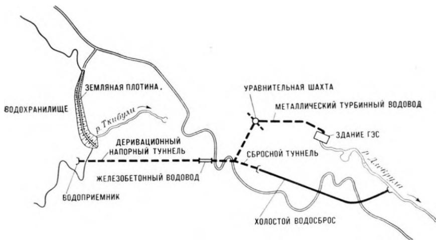
Рис. 2-71. Схема сооружений Ткибульской ГЭС.
