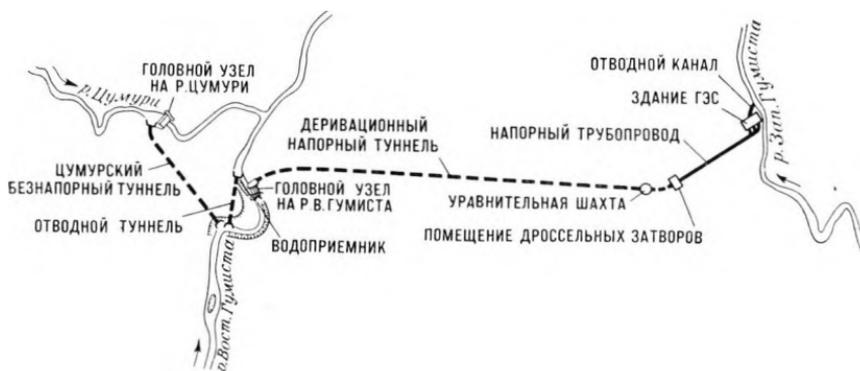
Рис. 2-87. Схема сооружений Сухумской ГЭС.
