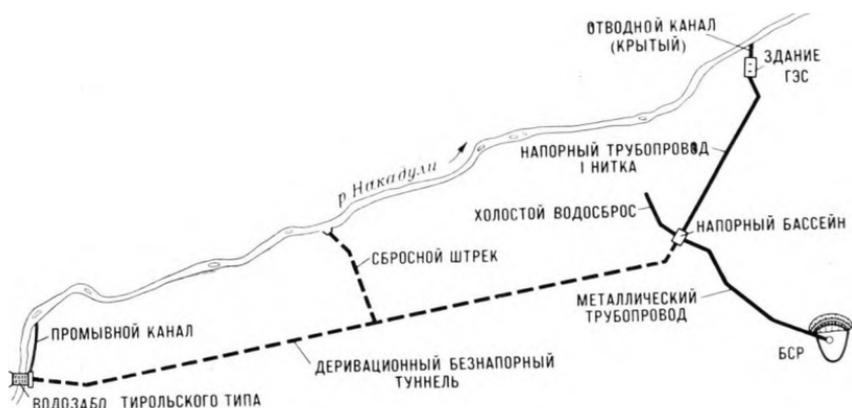
Рис. 2-92. Схема сооружений Багнарской ГЭС.
