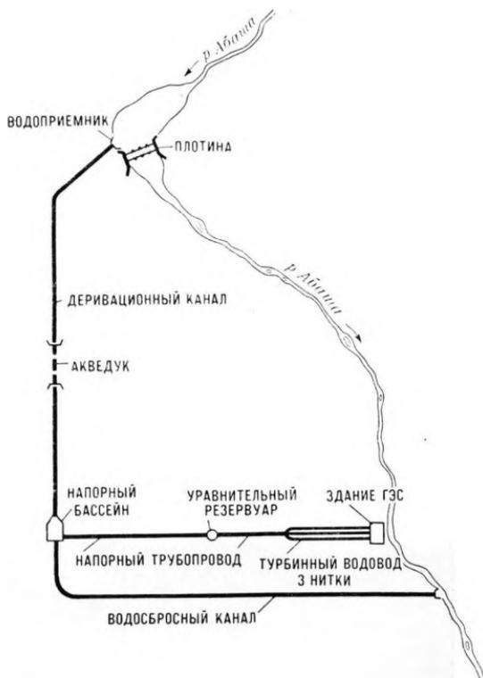
Рис. 2-77. Схема сооружений Абашской ГЭС.
