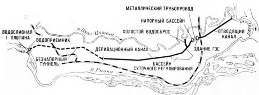
Рис. 2-21. Схема сооружений ГЭС.
