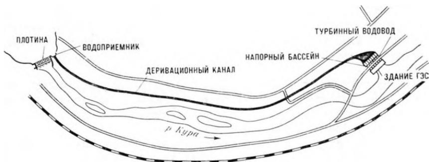
Рис. 2-2. Схема сооружений Земо-Авчальской ГЭС.
