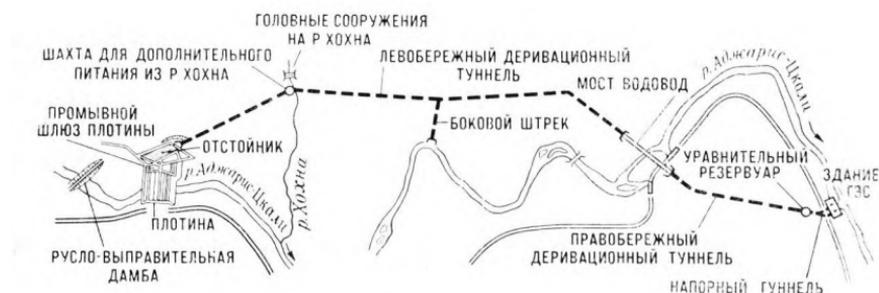
Рис. 2-80. Схема сооружений Аджарис-Цкальской ГЭС.
