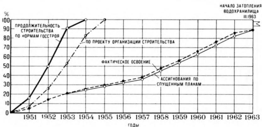
Рис. 2-56. График выполнения строительно-монтажных работ Сионской ГЭС.
