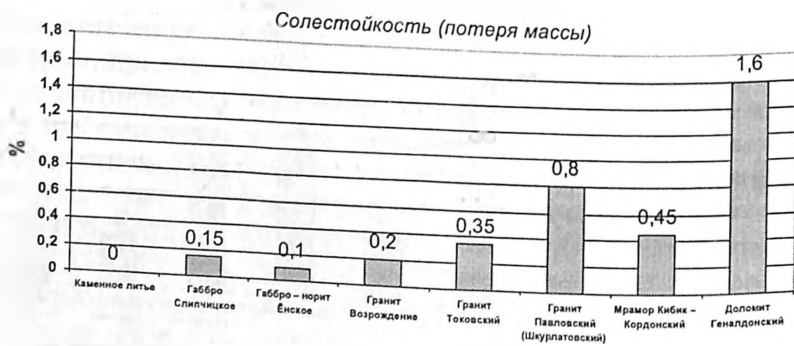
Рис. 6. Солестойкость (потеря массы) камня. Требования ГОСТ 9479-98: не более 5%.
