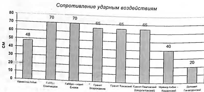
Рис. 5. Сопротивление камня ударным воздействиям. Требования ГОСТ 9479-98 для прочных пород - не менее 50 см, для среднепрочных пород - не менее 40 см.
