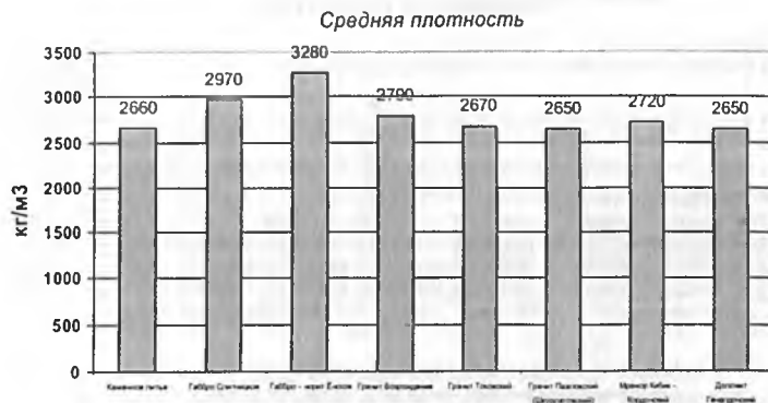
Рис. 1. Средняя плотность камня. ГОСТ 9479-98 требования по плотности камня не устанавливает.
