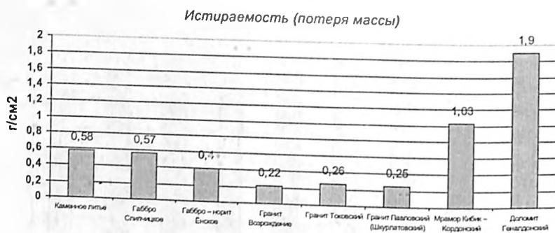
Рис. 4. Истираемость (потеря массы) камня. Требования ГОСТ 9479-98: при значительном воздействии - не более 0,5 г/см 2 , при умеренном воздействии - не более 1,0 г/см 2 .
