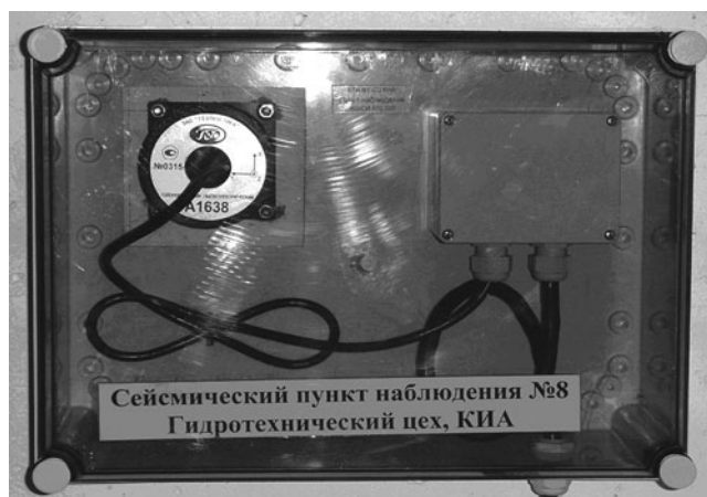
Рис. 2. Трехкомпонентный пьезоэлектрический датчик (А1638) в пункте наблюдения
